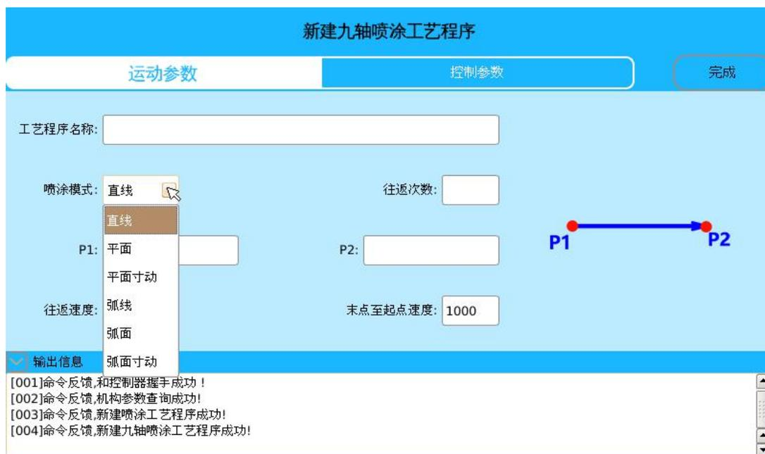
图 4.22 “九轴喷涂工艺”喷涂模式
