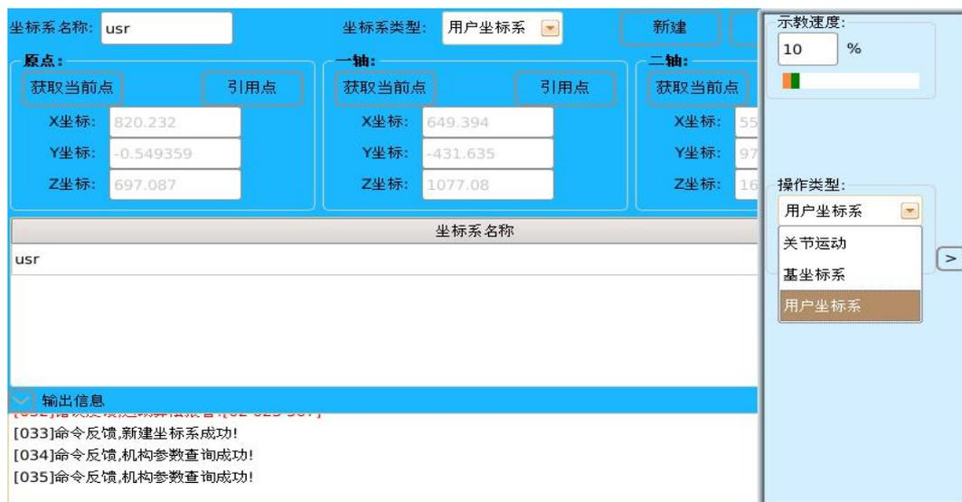
图 5.2 建立完成后的“用户坐标系”
