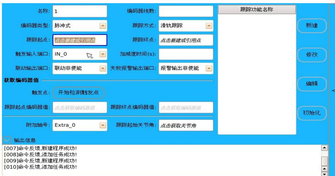
图 6.5 脉冲式编码器滑轨跟踪模式
