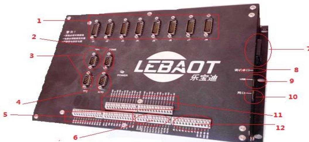
图 2.1 控制系统控制盒组成结构
